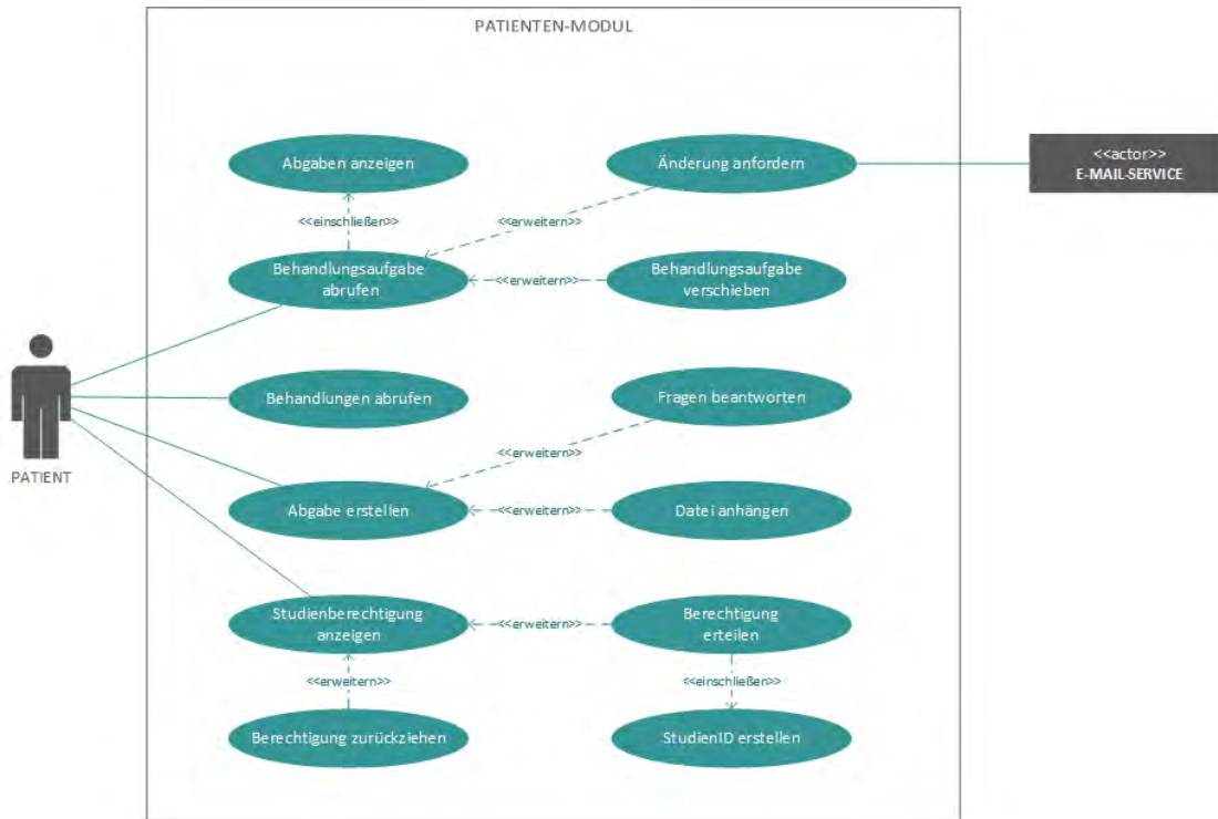
Abbildung 4.10: Anwendungsfalldiagramm für das Patienten-Modul
